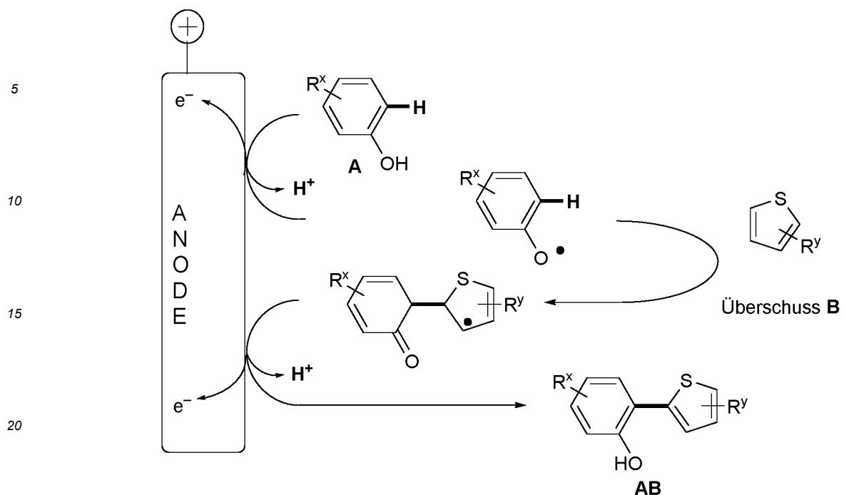
25 [0009] Im verwendeten Lösungsmittel (1,1,1,3,3,3-Hexafluorisopropanol) wird die Komponente A selektiv oxidiert. Die gebildete Radikalspezies wird vom Lösungsmittel stabilisiert und kann auf diese Weise selektiv nukleophil von Komponente B (Thiophen) angegriffen werden.
