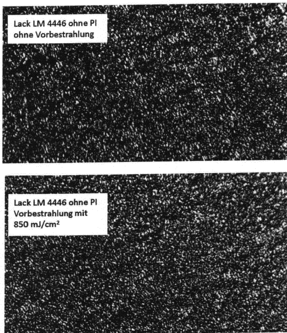
Abbildung 3: Beschichtung ohne Photoinitiator. Einfluss der Vorbestrahlung mit Hg-Niederdrucklampen auf die Oberflächenstruktur
