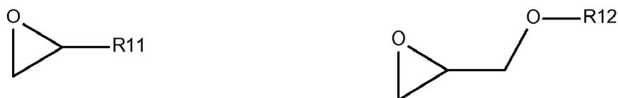
wobei R11 für Wasserstoff, einen C1-C22 Alkylrest, der durch Chlor, Brom oder Fluor substituiert sein kann oder einen Vinylrest steht und
