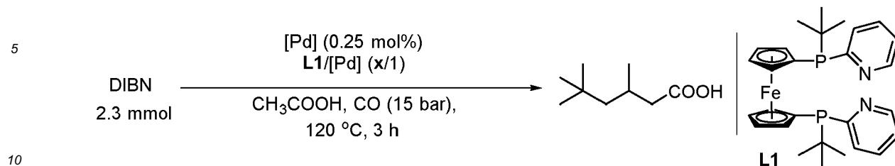
[0014] Ein 4-mL-Vial wurde mit  $[\text{Pd}(\text{acac})_2]$  (1,75 mg, 0,25 mol-%), L1 (4,44 mg, 0,375 mol-%),  $\text{H}_2\text{SO}_4$  (3,1 mg, 1,4 mol-%) und einem im Ofen getrockneten Rührstab beschickt. Dann wird das Vial mit Septen (PTFE-beschichteter Styrol-Butadien-Kautschuk) und Phenolharzdeckel verschlossen. Das Vial wird dreimal evakuiert und mit Argon wieder befüllt.
