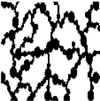
Abbildung 3b. Siliziumlegierungspulver nach dem Verdichten auf mäßige Wärmeleitfähigkeit bei etwa 1,1 \text{ g cm}^{-3} .
