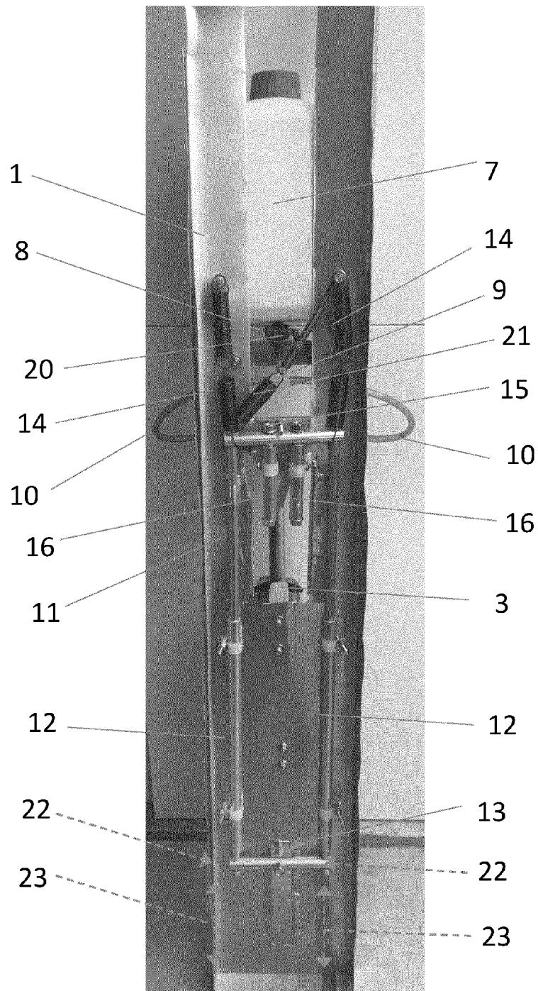
Führungsrollen (22) und Führungsschiene (23)
