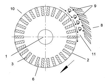
[0001] Die Erfindung richtet sich auf einen Zentrifugalkraft-Windsichter mit Sichtrad und Leitschaufelkranz nach dem Oberbegriff des Anspruchs 1 und ein Verfahren zur Trennung von in einem Sichtfluid dispergierten Sichtgut in eine Fein- und eine Grobfraktion nach dem Oberbegriff des Anspruchs 8.
