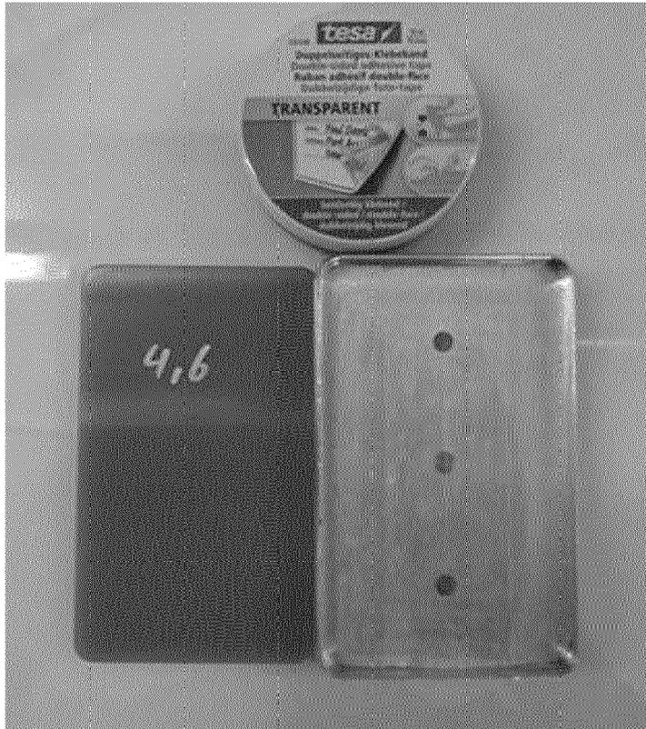
*Fig. 6: Aluminiumgehäuse und Kunststoffplatte als Probenaufnahme und Probendummy*
