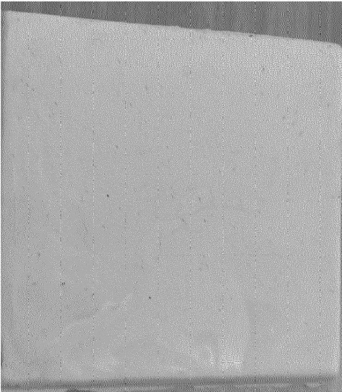
**Fig. 4:** Foto des Formteils aus der Formulierung gemäß Muster 3, Beispiel 2 mit 8,0 Gew.% Terpeneol, hergestellt gemäß dem Temperaturprofil nach Fig. 2
