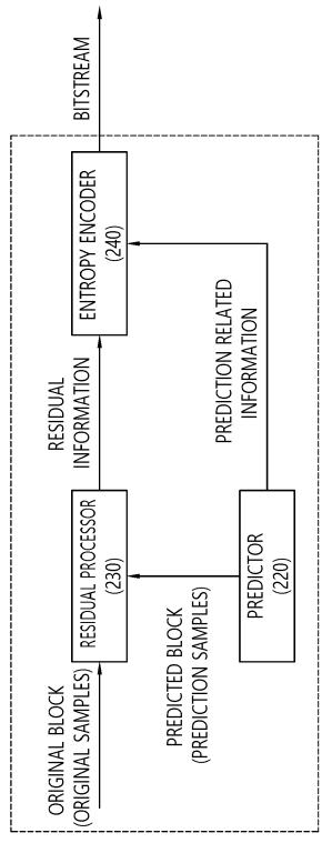
**ENCODING APPARATUS (200)**
